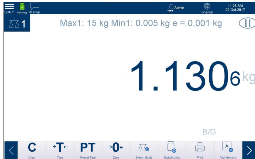
Figure 2-31 : Affichage du poids pour une plateforme de pesage IDNet classe d'étalonnage II
